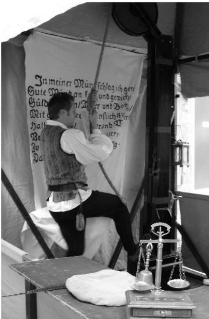
Die Wirkungsweise der sehr massiven Maschine ist so einfach wie beeindruckend. Ein Gewicht von 42 Kilo fällt nach unten und schlägt auf einer nur münzgroßen Fläche auf, auf die ein passender Metallrohling gelegt wurde. Je nach Fallhöhe entspricht dies einem Aufschlagdruck von rund 30 bis 50 Tonnen. Mit einem lauten Knall entsteht zwischen dem Ober- und Unterstempel bei jedem „Schlag“ ein kleines Kunstwerk in Silber oder Zinn oder anderen Metallen.
